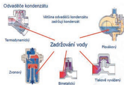
Obr. 22 Různé typy používaných odvaděčů kondenzátu
